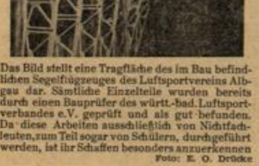
Das Bild stellt eine Tragfläche des im Bau befindlichen Segelfluggelüges des Luftsportvereins Albgau dar.
