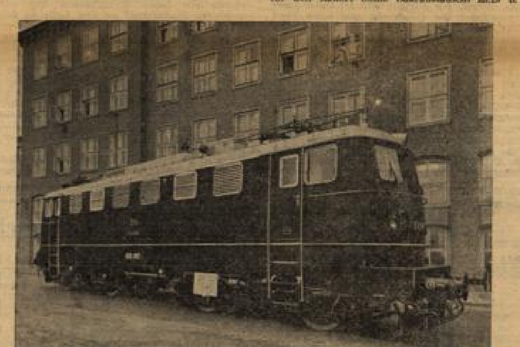
E 10 002 bei BBC in Mannheim Die Deutsche Bundesbahn wird in der nächsten Zeit fünf neue Lokomotiven der Reihe E 10 in Dienst stellen. Es handelt sich um die ersten Neukonstruktionen der Nachkriegszeit. Diese sind, wie eine der neuen Lokomotiven, die E 10 002, die auf dem Weg von Eisen nach München kurze Zeit auf dem Werksgelände der Brown, Boveri & Cie. AG, Mannheim, stand. Der mechanische Teil der Lokomotive wurde von Friedr. Krupp in Essen, der elektrische von BBC entwickelt und gebaut. Aufnahme: Brown Boveri
