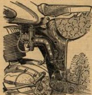
Die neue NSU-MAX wird mit „beruhigter“ Luft gespeist. Die Luft, die der Max-Motor für die Verbrennung benötigt, dringt durch verschiedene Öffnungen in das Mittelteil des Zentralpräbrenners ein. Diese Ansaugluft, mit Staub durchsetzt und stark wirbelnd, beruhigt sich und schlägt einen großen Teil des mitgeführten Staubes an den Innenflächen des weiträumigen Rahmens nieder. Dann passiert sie den großen Luftfilter und strömt, inzwischen völlig „beruhigt“, weiter zum Vergaser. (Zeichnungen 2: NSU)
