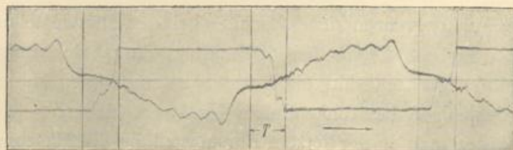
Fig. 45. Feldkurve und Strom einer Spule. Tourenzahl n = 500 . Erregung i_e = 1,15 Ampère. Strom J = 37,5 Ampère. Spannung E = 69,5 Volt. Bürsten 16,6^\circ in der Drehrichtung ver- schoben. Bürstenbreite b = 30 mm. Funkenfrei.
