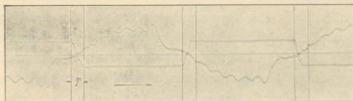
Fig. 46. Feldkurve und Strom in einer Spule. Tourenzahl n = 500 . Erregung i_e = 1,15 Ampère. Strom J = 32 Ampère. Spannung E = 97 Volt. Bürstenbreite b = 30 mm. Bürsten um 16,6^\circ gegen die Drehrichtung verstell. Funken unter der auflaufenden Kante der positiven Bürste.
