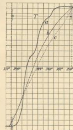
Fig. 9. a: mit dem Kontaktgeber aufgenommene Kurzschlussstromkurve, b: aus der Kurve der mittleren örtlichen Stromdichte konstruierte Kurzschlussstromkurve, c: desgl. aus der \Delta P -Kurve abgeleitet.
