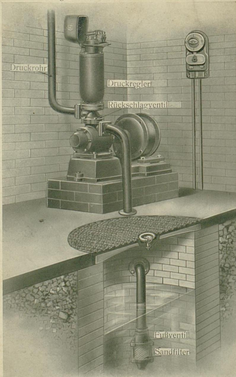
Elektrisch angetriebene Hauswasserpumpe
