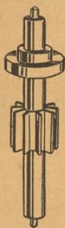
Massivtrieb. Welle und Trieb sind eins, aus Stahl gedreht und mit gefrästen Walzenzähnen.
