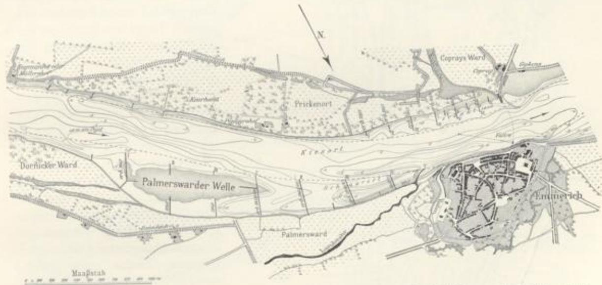
Abb. 118. Stand der Regulierungsarbeiten an der Palmswarder Welle oberhalb Emmerich im Jahre 1874, mit Tiefenlinien von 1860.
