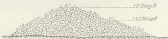
Abb. 14. Querschnitt der Buhnen Nr. VIII bis XXIII am linken Ufer bei Bingerbrück vom Jahre 1860.
