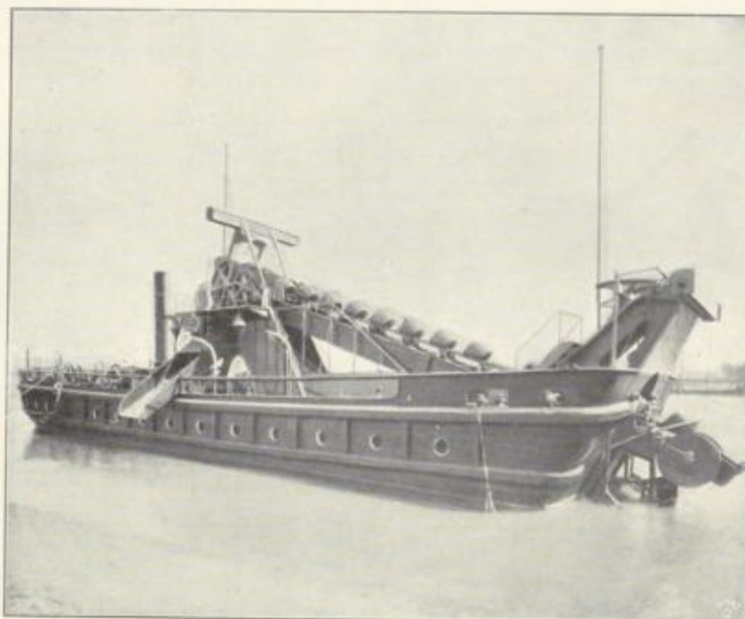
Abb. 12. Dampfbagger Roland, erbaut 1884, verstärkt 1894.
