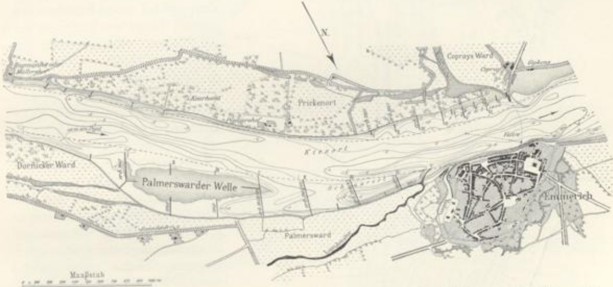
Abb. 118. Stand der Regulierungsarbeiten an der Palmerswarder Welle oberhalb Emmerich im Jahre 1874, mit Tiefenlinien von 1860.
