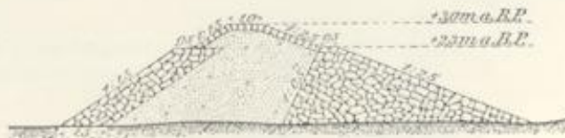
Abb. 45. Querschnitt der im Jahre 1881 an der Herseler Insel erbauten Buhnen I bis XVI.
