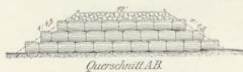
Abb. 63b. Querschnitt A-B durch eine Kopfschwelle.
