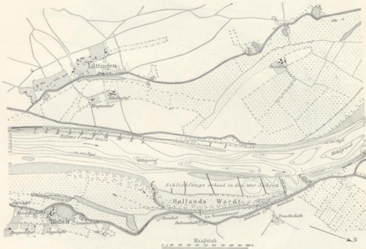
Abb. 114. Regulirung an der Hollandswelle, Stand der Arbeiten im Jahre 1874, mit Tiefenlinien von 1860.
