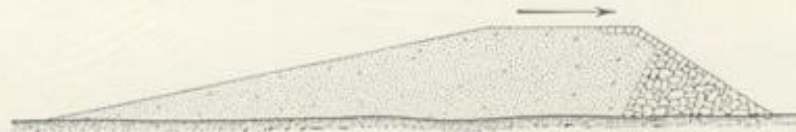
Abb. 71. Querschnitt einer Kiesbühne seit dem Jahre 1882.
