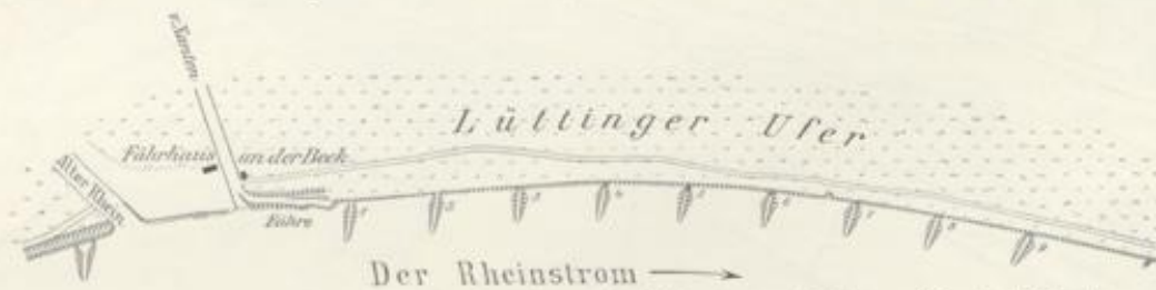
Abb. 63. Uferdeckung mit Kopfschwellen (Nobilings) am Lüttinger Ufer bei Xanten.
