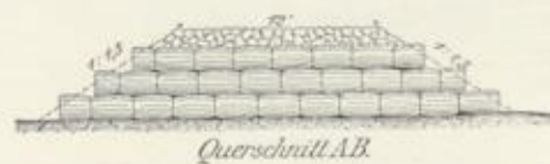
Abb. 63b. Querschnitt A-B durch eine Kopfschwelle.
