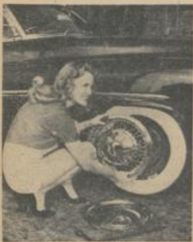
Ein Handgriff genügt und schon ist die normale Radkappe durch eine Maske aus Chrom ersetzt, die den äußerlichen Eindruck erwecken soll, daß der Wagen mit sportlichen Speichenrädern ausgerüstet ist. Eine amerikanische Firma in Los Angeles wurde dadurch zu dieser Konstruktion angeregt, daß zahlreiche Autofabriken in aller Welt besonders ihre teuren Modelle mit Speichenrädern ausstatten. ap-Foto
