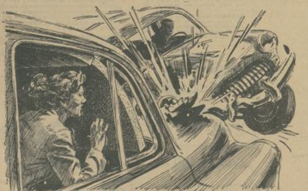
Eine neuartige Erfindung zum Schutze des Fahrpastes auf dem sogenannten „Todesitz“ ist eine Schwammgummi-Matte, die sich bei einem Zusammenstoß sofort über Scheibe und Armaturenbrett schiebt. Die Auslösung erfolgt über elektrische Kontakte an der Stofstange.
