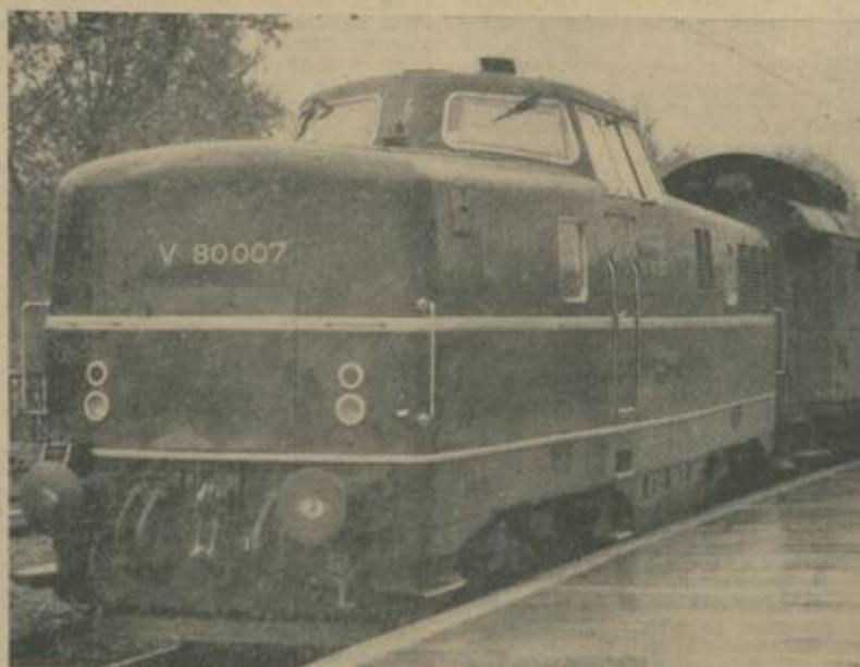
In Zusammenarbeit mit der deutschen Industrie hat die Deutsche Bundesbahn eine Diesellokomotive entwickelt, die sowohl Güter- wie Reisezüge befördern kann. Bei der im Bild dargestellten Maschine handelt es sich um eine Lokomotive mittlerer Leistung mit 800 bis 1000 PS. Die Lokomotive V 80 verfügt über Fernsteuerung und eine vollautomatisch arbeitende übertaktete Dampfheizung.
