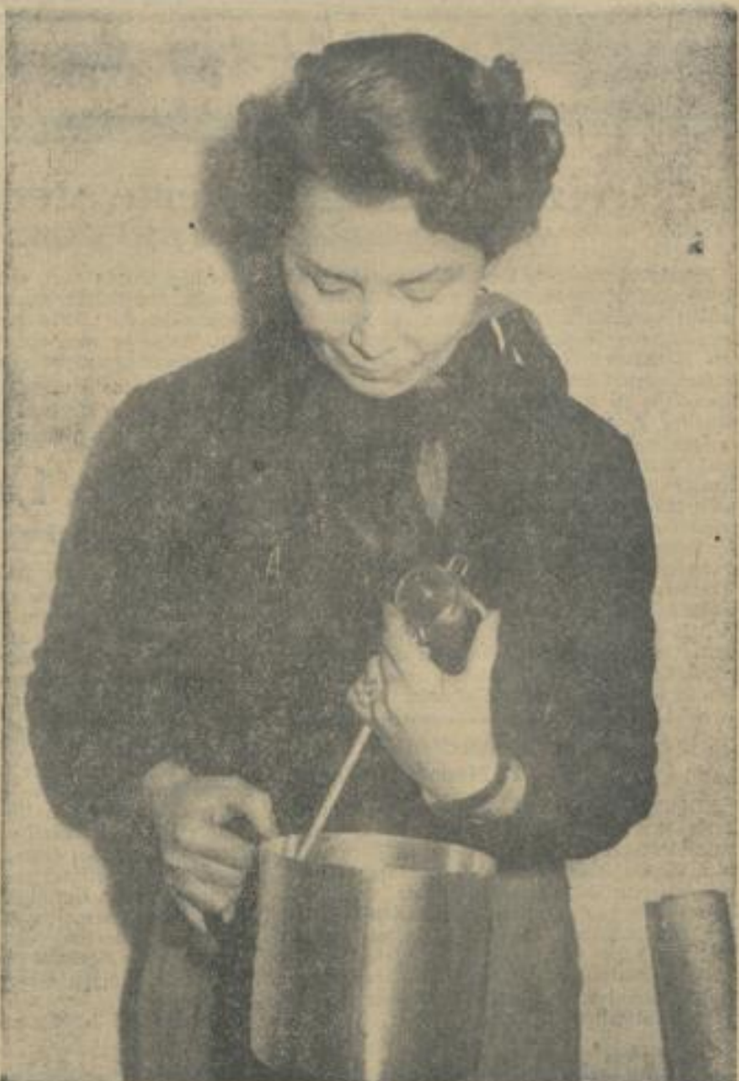
Eine interessante Erfindung auf der hannoverschen Ausstellung „Fortschritt im Alltag“ stellt dieses „Milchglöckchen“ dar, das sofort Alarm schlägt, wenn sich das Kochgut auf 93 Grad erhitzt hat. Die Hausfrau spannt an der Glocke einen Hebel und setzt den Stab, der als Wärmeleiter fungiert, in die Flüssigkeit. Sobald die Kochgrenze erreicht ist, erschallt ein lauter Glockenton und warnt. Foto: Friedrich
