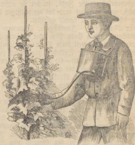
Fig. 1. Vorrichtung zum Vergiften des Heuwurms.
