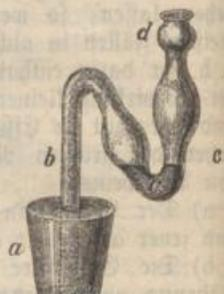
Ist die Röhre auf einem Gefäß befestigt und es entsteht Kohlensäure in letzterem, so wird das Glycerin in die eine Röhre c gedrückt und die Kohlensäure kann entweichen; läßt man Flüssigkeit ab, so steigt das Glycerin in die andere etwas erweiterte Röhre d und es dringt Luft in das Gefäß. Sobald der Druck inner- und außerhalb des Gefäßes ausgeglichen ist, sinkt das Glycerin wieder in den unteren Theil der Röhre und schließt die Luft ab.
