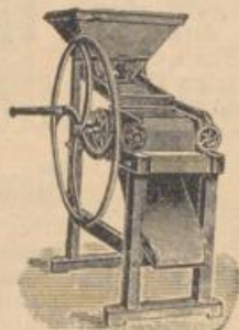
Schrotmühlen mit Walzen und Mahlscheiben
