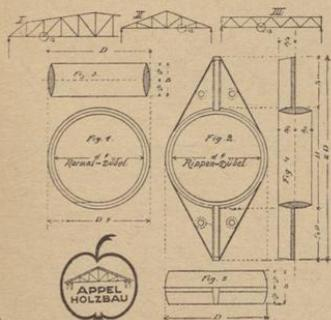
Die Dübel sind in 8 verschiedenen Normal-Größen lieferbar, je nach Erfordernis für eine zulässige Belastung bei dreifacher Sicherheit von **2700 kg** bis **12 000 kg** je einer Normalverbindung.
