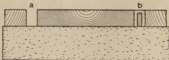
Querschnitt durch den Teil eines stark geschwundenen (f. a) Fußbodens. Die Fugen sind mit einem Holzspan (f. b) und der übrige Hohlraum des Risses mit flüssigem Holz Marke »Holzkitt Rottit« ausgefüllt.
