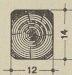
Abb. 3. Das vierseitige Bauholz nach den Vorschriften des Reichsverbindungsausschusses.
