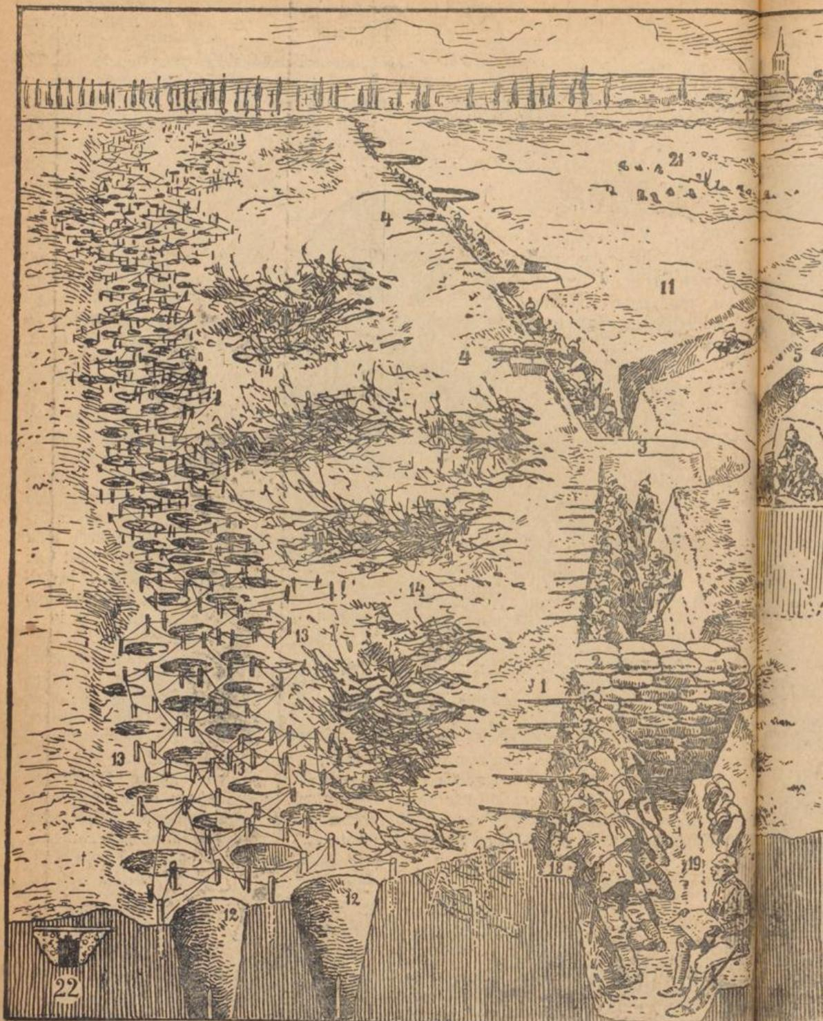
Abb. 2. Schema einer Anlage von Schützengräben
