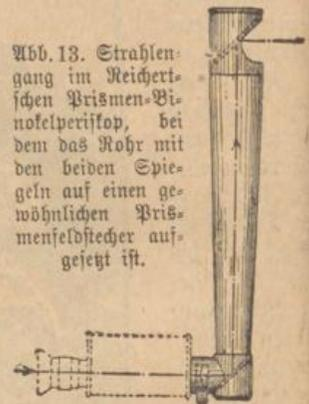
Abb. 13. Strahlengang im Reichert'schen Prismen-Periskop, bei dem das Rohr mit den beiden Spiegeln auf einen gewöhnlichen Prismenfeldstecher aufgesetzt ist.
