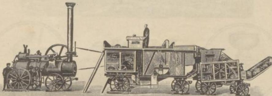
**Lokomobilen, Dampfdreschmaschinen und Patent-Heißdampf-Lokomobilen,
