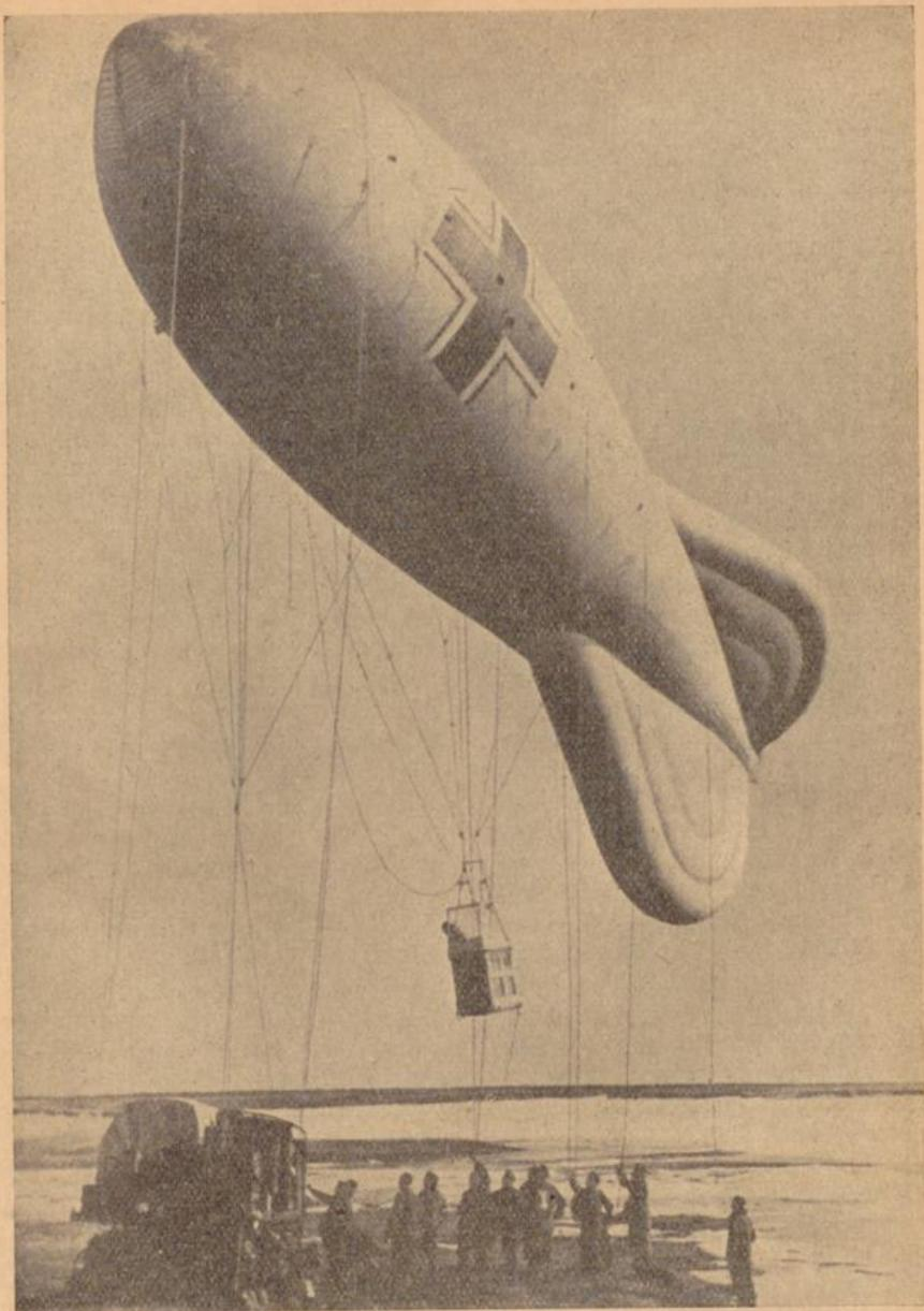
Ballon hoch! An dem Drahtseil, das auf dem Wagen der Motorwinde über eine gewaltige Kabeltrommel läuft, wird der Ballon hochgelassen. Der Beobachter hat in dieser luftigen Höhe einen Überblick über das ganze Gelände und gibt seine gemachten Beobachtungen sofort der vorgefetzten Dienststelle weiter.
