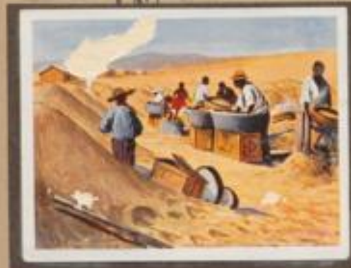
143 Diamantengewinnung bei der Heimatschube (südlich von Lüderitzbucht). Der durch Sieben von Schutt abgetrennte Kies wird teilweise noch mit der Hand in Sieben gesiebt und gefertigt, um der Diamant kann ausgelesen.
