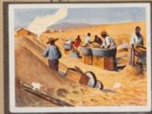
143 Diamantengewinnung bei der Holmanafubbe (nördlich von Lüderitzbucht). Der durch Sieben von Schutt und Steinen wird teilweise noch mit der Hand in Eichen gemischt und gesiebt, um der Diamant kann ausgelesen.
