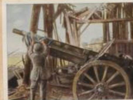
137 Röhrlung einer Geschützröhre. Die Durchbrüche des Jahres 1917 – Nivelle-Offensive, Verdun, Flandern, Cambrai – setzten an die Geschütze ungeheure Anforderungen. Die Rohre wurden oft glühend heiß und mussten häufig ersetzt werden, damit die Schussleistungen nicht nachließen.
