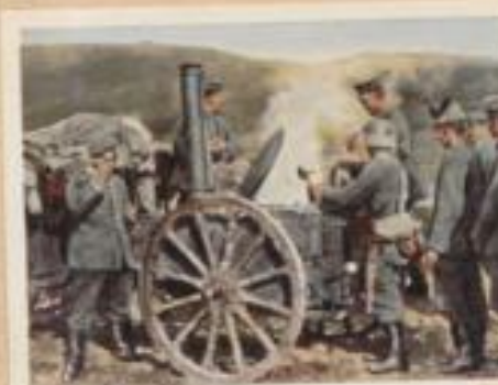
124 Wasserempfang an der Frontlinie. Zur Versorgung der Truppen hinter die auch heute noch selten fehlenden Feldleitungen. Der Vorkriegswagen (Dresde) wurde für den Transport des Behälters und der Nachschubmittel benutzt. Im Winterwagen befindet sich der Behälter mit einem großen Spindelrad, der 200 Liter fasste, sowie ein kleinerer Behälter von 70 Litern für die Zubereitung kalten Getränks.
