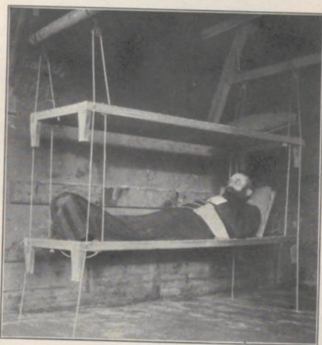
Abb. II. Die Tragen zu Abb. I in Verwendung beim Eisenbahntransport; mit Drahtseilstricken eingehängt.
