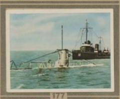
"U 9" beim Tauchmanover. Durch Tluten ber Tauchtants erhält bas U-Boot bas jum Lauchen erforderliche Gewicht. Jum Auftauchen werden die gestuteten Tanks mittels Preflust entleert.
