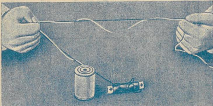
Je ein Seidenfaden und ein anderer Faden werden, wie auf der Abbildung gezeigt, so um zwei Finger gewickelt, daß beide Fäden gleichmäßig angespannt sind. Spannt man nun den Faden langsam mehr und mehr bis zum Bruch, so wird immer der „andere Faden“ zuerst reißen, auch wenn ein wesentlich dünnerer Seidenfaden zum Vergleich genommen wurde. — Ein Beweis für die unübertroffene Haltbarkeit der Seide.
