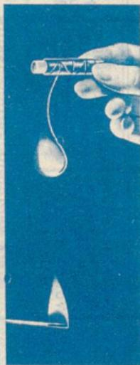
Der **Baumwollfaden** (auch merzerisiertes Garn) sowie der Kunstseidenfaden brennen hell auf, hinterlassen nur kleine Rückstände, die der geringste Wind fortbläst. Geruch nach verbranntem Papier.
