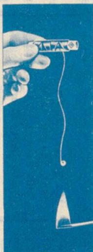
Der **Seidenfaden** wird über eine Flamme gehalten; er brennt nicht oder nur träge, und es bildet sich eine am Faden haftende Asche in Form eines koksartigen Knötchens mit einem Geruch nach verbranntem Horn.
