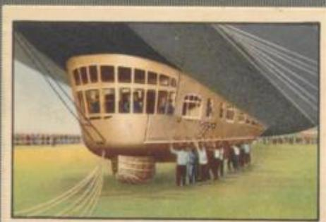
Nr. 3 Führergondel eines Zeppelin-Luftschiffes.
