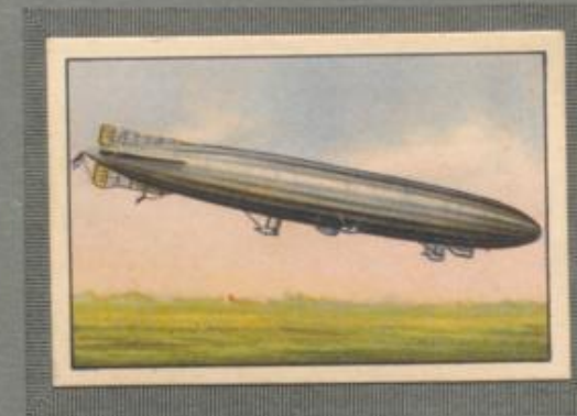
Nr. 12 Schütte-Lanz (späterer) Die späteren Schütte-Lanz-Luftschiffe waren wie die Zeppeline mit einem Dur-Aluminium-Gerüst versehen.
