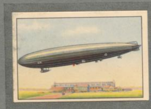
Nr. 9 Marine-Luftschiff „L 71“ Gebaut 1918. Inhalt: 62 200 cbm, Länge: 211,5 m, Durchmesser: 23,9 m. 6x290-PS-Maybach-Motoren = 1740-PS. Geschwindigkeit 130 km stündlich. 1920 wurde es an England abgeliefert.
