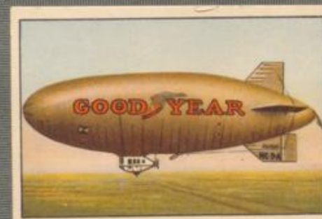
Nr. 10 „Pilgrim“ der Good-Year-Gesellschaft U. S. A. Luftschiff. Gebaut 1925. Inhalt: 1490 cbm, Länge: 32,3 m, Durchmesser: 9,45 m. 60-PS-Wright-Sternmotor. Geschwindigkeit 72 km stündlich.
