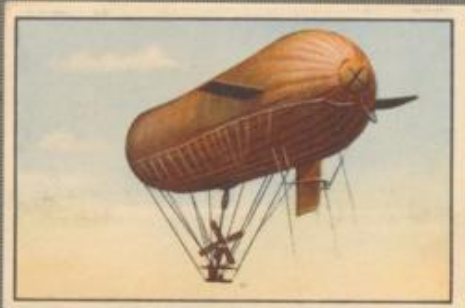
Nr. 1 Parseval I (erster Parseval) Gebaut 1906. Unstarrer Typ. Inhalt: 2300 cbm, wurde später auf 2800 cbm vergrößert. Länge: 50 m, Durchmesser: 8,9 m. 85-PS-Daimler-Motor mit 4 flügeliger Stoffschraube. Geschwindigkeit 42 km stündlich.
