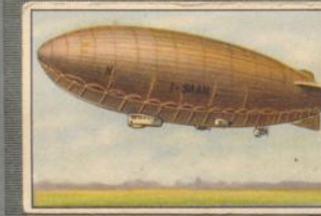
Nr. 12 N-I Norge Halbstarres, italienisches Passagier-Luftschiff, 1923 gebaut von der Stabilimento Costruzioni Aeronautica in Rom. Inhalt: 19 000 cbm, Länge: 106 m, Durchmesser: 19,5 m. 3x240-PS-Maybach-Motoren. Geschwindigkeit 100 km stündlich. Mit dem Schiff führte Amundsen im Jahre 1926 eine Nordpol-Expedition durch.
