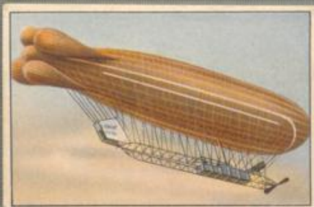
Nr. 7 Clement Bayard Französischer, 1908 gebauter unstarrender Typ mit langer Gittergondel. Gleichgewichtsflossen in Form gasgefüllter Säcke am Schwanzende. Inhalt 8000 cbm. Ein großer Propeller an der Gondelspitze.
