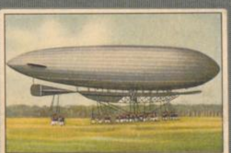
Nr. 4 Erstes Militär-Luftschiff M I Typ Groß-Basenach, gebaut bei der Inspektion der Verkehrstruppen 1908. Inhalt: 5000 cbm, Länge: 65,5 m, Durchmesser: 11,1 m. 2x75-PS-Körting-Motoren. Geschwindigkeit 50 km stündlich.
