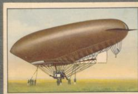
Nr. 9 Ville de Paris Inhalt: 3200 cbm, 70-PS-Motor. Es machte am 11. 11. 06 eine Probefahrt und nach Umbau im Jahre 1908 eine Fahrt von 9 Stunden 25 Minuten.
