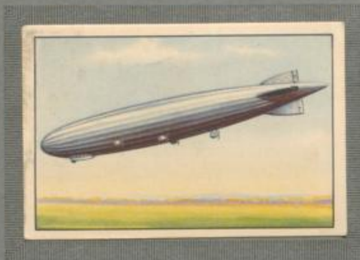
Nr. 7 LZ 126 (R Z III „Los Angeles“) Gebaut 1924. Inhalt: 70 000 cbm, Länge: 200 m, Durchmesser: 27,6 m. 5 Maybach-Motoren = 2000-PS. Geschwindigkeit 125 km stündlich. Verkehrsluftschiff auf Reparationskonto gebaut. 1924 an U. S. A. abgeliefert und führt heute den Namen „Los Angeles“.
