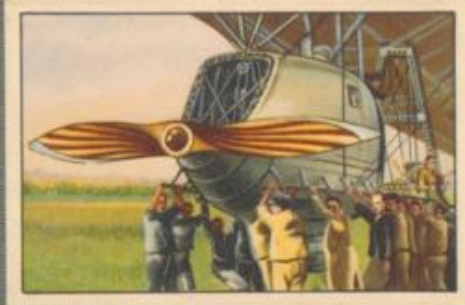
Nr. 2 Motorgondel eines Zeppelin-Luftschiffes.
