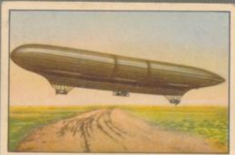
Nr. 3 Siemens-Schuckert Unstarrtes Lenk-Luftschiff aus dem Jahre 1911. Inhalt: 13 500 cbm, Länge: 120 m, Durchmesser: 13,5 m. 4 Daimler-Motoren von je 120 PS.
