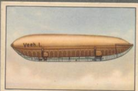
Nr. 5 Veeh-Luftschiff Halbstarres Lenk-Luftschiff. Inhalt: ca. 1700 cbm, Länge: 76 m, Durchmesser: ca. 13 m. Die Gondeln sind in den von der Spitze zum Heck verlaufenden Verstärkungsträger eingebaut. 2 Motoren.
