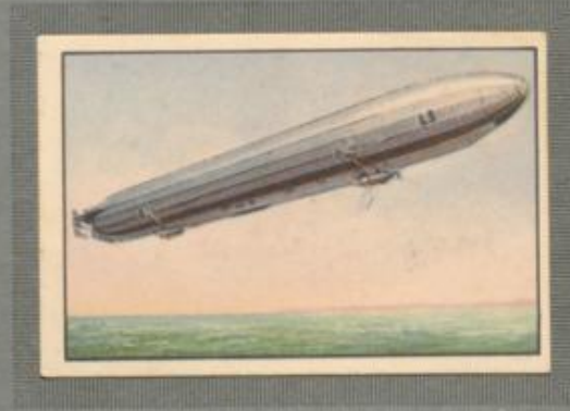
Nr. 8 Marine-Luftschiff „L 3“ Inhalt: 22 500 cbm, Länge: 158 m, Durchmesser: 14,8 m. 3 Motoren mit insgesamt 650-PS. Seine erste Fahrt machte es im Jahre 1914. Am 17. 2. 1915 an der Küste von Fanö gestrandet.
