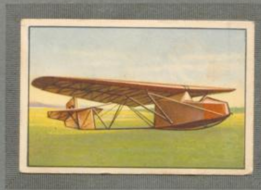
Nr. 2 B. S. V. Fliege des Berliner Segelflug-Vereins Stahlrohr-Gitterrumpf mit verkleidetem Führersitz.
