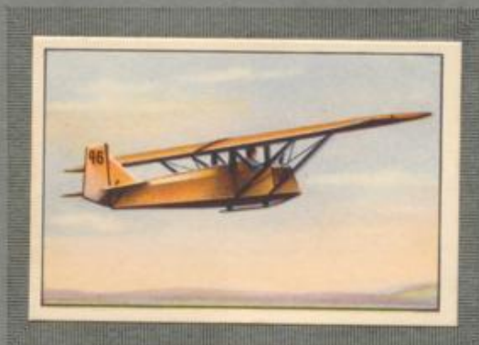
Nr. 3 Übungs-Flugzeug Prüfling (R. R. G.) Schul-Flugzeug für Fortgeschrittene und Übungsflugzeug, Gleitwinkel 1 : 20. Fluggeschwindigkeit 65—70 km stündl.
