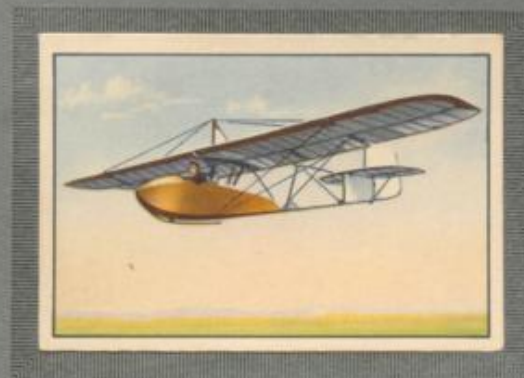
Nr. 6 Hangwind Schul-Flugzeug für ungünstige Aufwind- Verhältnisse, Gleitwinkel 1 : 15. Flug- geschwindigkeit 55—60 km stündlich.
