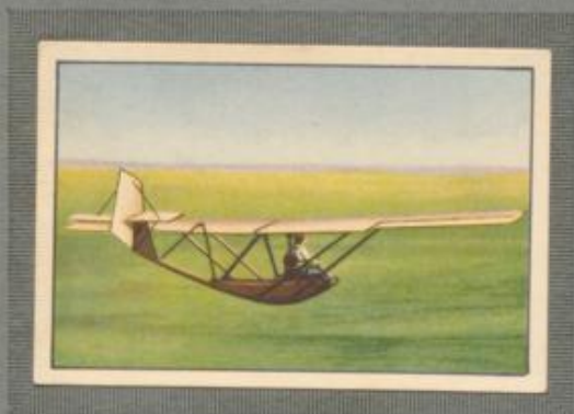
Nr. 1 Zögling (R. R. G.) Anfänger - Schulgleit - Flugzeug, Gleit- winkel 1 : 10. Fluggeschwindigkeit 45 bis 50 km stündlich.
