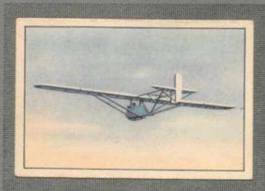
Nr. 5 Verkleideter Zögling zur Verbesserung des Gleitwinkels.
