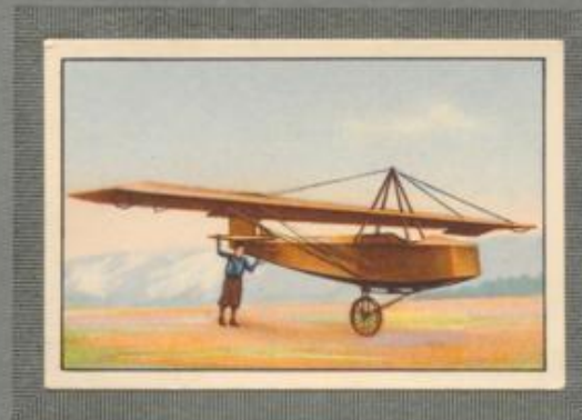
Nr. 4 Rumpf-Schul-Flugzeug Grunau (R. S. G.) Schul-Flugzeug für Fortgeschrittene und Übungsflugzeug, Gleitwinkel 1 : 15. Fluggeschwindigkeit 55—60 km stündl.
