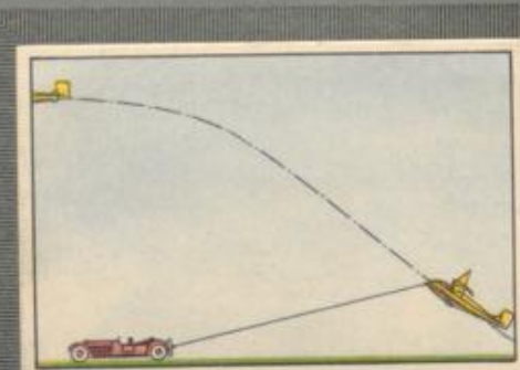
Nr. 11 Autostart zum Segelflug Durch diese Startmethode wurde der Segelflug-Sport in der Ebene erst möglich.
