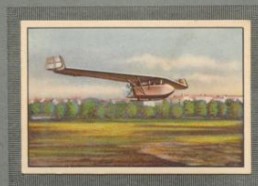
Nr. 3 R. R. G. „Storch IV“ Schwanzloses Versuchs-Sportflugzeug der Rhön-Rossitten-Gesellschaft. 12-PS-DKW Motor, luftgekühlt.
