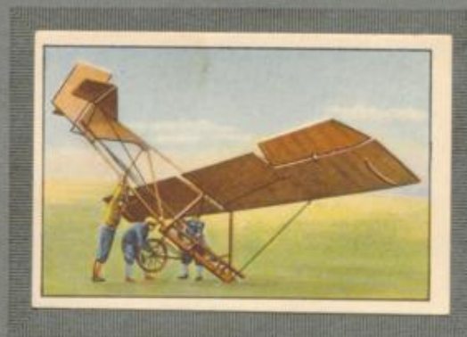
Nr. 2 Einheits-Flugzeug Grunau (E. S. G. 29) Anfänger - Schulgleit - Flugzeug, Gleit- winkel 1 : 10. Fluggeschwindigkeit 55 bis 60 km stündlich.
