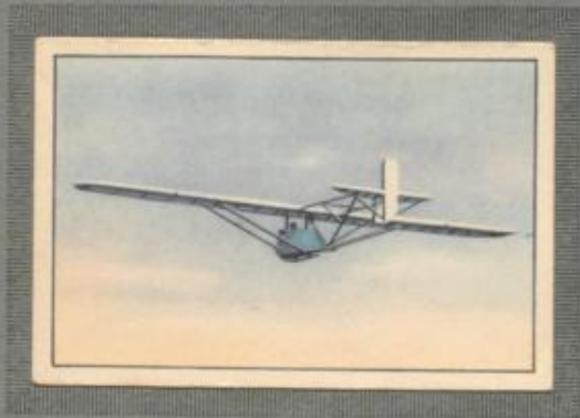
Nr. 5 Verkleideter Zögling zur Verbesserung des Gleitwinkels.
