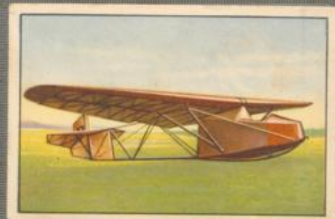
Nr. 2 B. S. V. Fliege des Berliner Segelflug-Vereins Stahlrohr-Gitterrumpf mit verkleidetem Führersitz.
