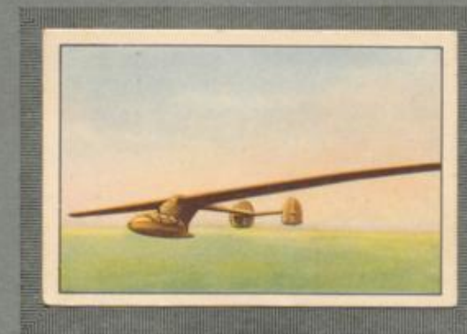
Nr. 6 Austria mit exorbitantem Gleitwinkel 1 : 35, freitragend, mit 30 m Spannweite, größtes existierendes Segelflugzeug.
