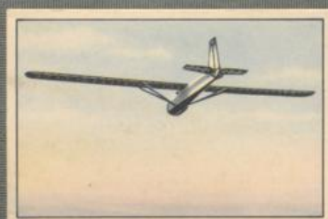
Nr. 3 Mayer M I Segel-Flugzeug für den Selbstbau in Segelflug-Vereinen. Ein Dauerflug von 8 Stunden 22 Minuten erbrachte den Beweis der Leistungsfähigkeit.
