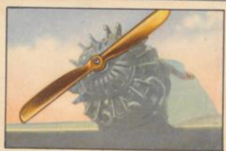
Nr. 2 2 flügelige Holzluftschraube für großes Verkehrsflugzeug der Schwarz-Propeller-Werke.
