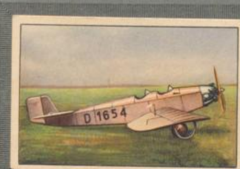
Nr. 5 Klemm L 25 2 sitziges Sportflugzeug. 40-PS-BMW X Motor, luftgekühlt.
