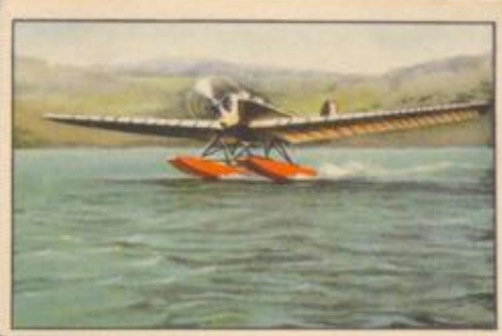
Nr. 4 Klemm WL 25 la 2 sitziges Sportflugzeug auf Schwimmern. 40-PS-Salmson AD 9 Motor, luftgekühlt.
