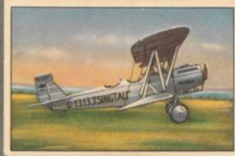
Nr. 2 Heinkel HD 24 L „Tsingtau“ 2-sitziges Sportflugzeug auf Landfahr-gestell für Günther Plüschow. 230-PS-BMW IV Motor, wassergekühlt.
