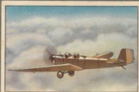
Nr. 6 Klemm L 25 la 2 sitziges Sportflugzeug, 40-PS-Salmson-Motor, luftgekühlt.
