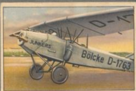
Nr. 1 Junkers T 26 E 2 sitziges Sportflugzeug. 80-PS-Junkers L 1 Motor, luftgekühlt.
