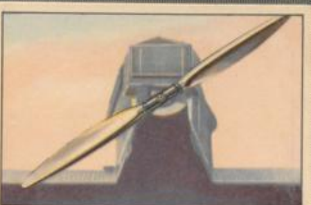
Nr. 6 Junkers Metall-Luftschraube mit im Fluge verstellbaren Flügeln.
