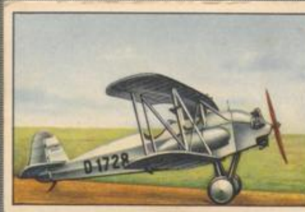
Nr. 6 Focke-Wulf S 24 A „Kiebitz“ 2-sitziger Sportdoppeldecker für Lang- streckenflüge mit Seitentanks. 70-PS- Siemens Sh 13 Motor, luftgekühlt.
