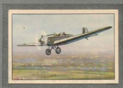
Nr. 24 Messerschmitt B.F.W. M 23b 2 sitziges Sportflugzeug auf Landfahr- gestell. (Siegerflugzeug im 1. Europa- rundflug 1929.) 80-PS-Siemens Sh 13 Mo- tor, luftgekühlt.
