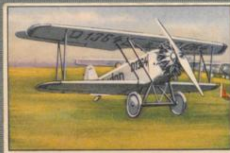
Nr. 27 Raab-Katzenstein KI 1c 2 sitziger Sportdoppeldecker. 80-PS- Siemens Sh 12 Motor, luftgekühlt.
