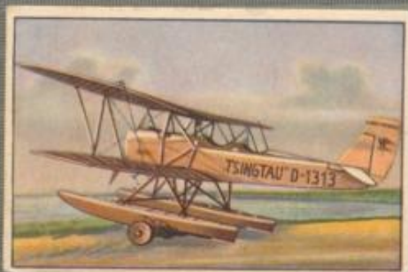
Nr. 1 Heinkel HD 24 W „Tsingtau“ 2-sitziges Sportflugzeug auf Schwimmern für Günther Plüschow. 230-PS-BMW IV Motor, wassergekühlt.
