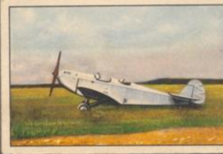
Nr. 6 Klemm FL 27 Va Frachtleichtflugzeug. 80/100-PS-Argus As 8 Motor, luftgekühlt.
