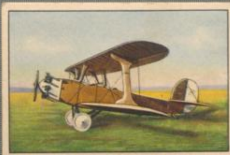
Nr. 3 B. F. W. U 12b „Flamingo“ Schul- und Kunstflugdoppeldecker, 2-sitziges Sportflugzeug. 100-PS-Siemens Sh 14 Motor, luftgekühlt.
