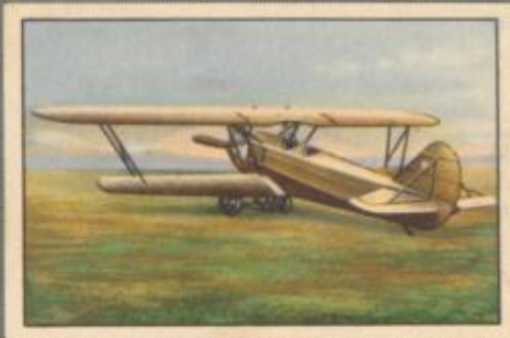
Nr. 32 Arado SC II 2 sitziger Übungsdoppeldecker. 350-PS-BMW IV Motor, wassergekühlt.
