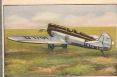
Nr. 28 Raab-Katzenstein RK 25 2 sitziger Sporthochdecker für Schnell- reisen. 80-PS-Citrus Mark II Motor, luft- gekühlt.
