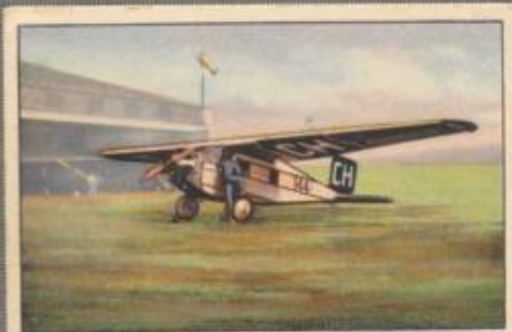
Nr. 5 Messerschmitt B. F. W. M 18 „Photo“ Spezial-Flugzeug für Vermessungsarbeiten, Gipfelhöhe 7000 m. 220-PS-Siddeley-Lynx-Motor, vorverdichtet, luftgekühlt.
