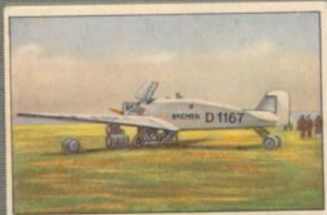
Nr. 1 Junkers W 33 L Frachtflugzeug. (D 1167, die von Köhl, Hünefeld und Fitzmaurice für den 1. Ost-West-Transozeanflug benutzte „Bremen“.) 310-PS-Junkers L 5 Motoren, wassergekühlt.
