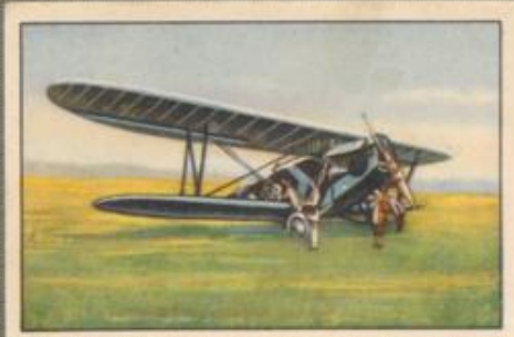
Nr. 7 Heinkel HD 39 Spezial-Fracht- und Zeitungstransport- flugzeug. 230-PS-BMW IV Motor, wasser- gekühlt.
