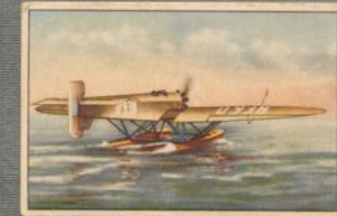
Nr. 6 Heinkel HE 5b Post- und Kurierflugzeug auf Schwimm- mern. 420-PS-Gnôme-Rhône Jupiter Mo- tor, luftgekühlt.
