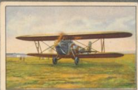
Nr. 8 Heinkel HD 40 Spezial-Fracht- und Zeitungstransport- flugzeug. 500-PS-BMW VI Motor, wasser- gekühlt.
