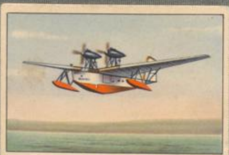
Nr. 11 Rohrbach „Rostra“ Frachtflugboot für 1100 kg Belastung. 2x525-PS-Gnome-Rhône-Jupiter Motoren, wassergekühlt.
