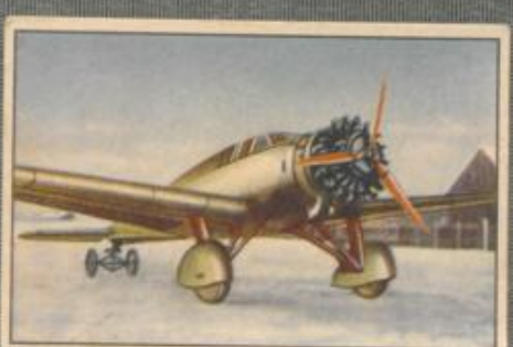
Nr. 12 Messerschmitt B. F. W. M 28 Spezial-Postflugzeug. 500-PS-BMW Hornet Motor, luftgekühlt.
