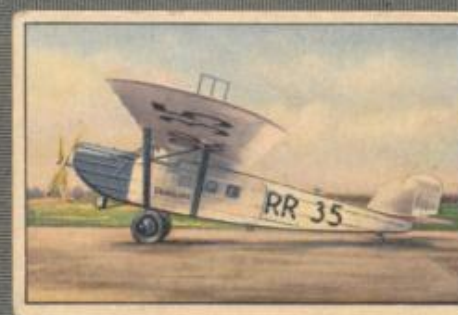
Nr. 24 Dornier „Merkur“ Verkehrsflugzeug auf Landfahrgerüst, Kabine für 8 Fluggäste. 600-PS-BMW VI Motor, wassergekühlt.
