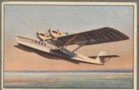
Nr. 27 Dornier „Superwal“ 4 motoriges Verkehrsflugboot, Kabine für 18–20 Fluggäste. 4x450-PS-Napier- Motoren, wassergekühlt.
