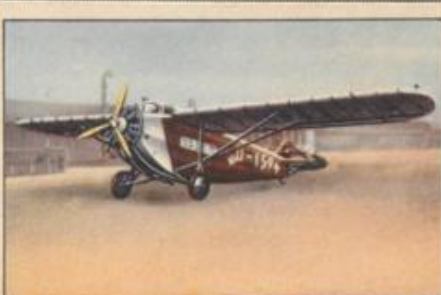
Nr. 6 Arado V 1 Verkehrsflugzeug, Kabine für 4 Flug- gäste oder Post und Fracht. 500-PS- Pratt & Whitney Hornet Motor, luft- gekühlt.
