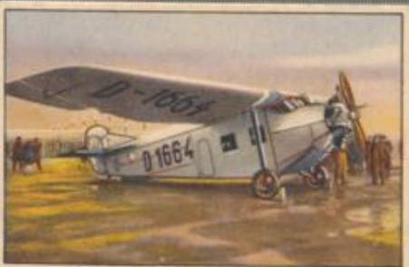
Nr. 5 Focke-Wulf A 28 „Habicht“ trudelsicheres Reise- und Kleinver- kehrsflugzeug. Kabine für 4 Fluggäste. 230/240-PS-Titanmotor, luftgekühlt.
