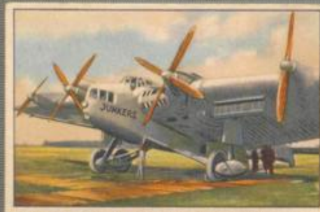
Nr. 20 Junkers G 38 Größtes Ganzmetall-Verkehrsflugzeug der Welt. 2x620-PS-Junkers L 55 Motoren, 2x310-PS-Junkers L 5 Motoren, wasser- gekühlt.
