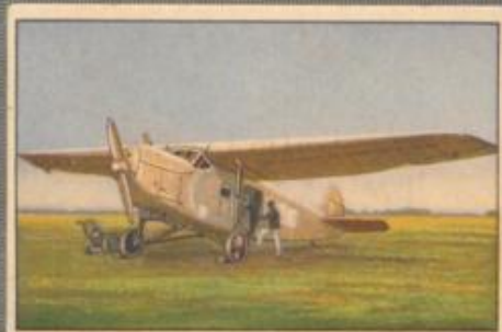
Nr. 7 Focke-Wulf A 32 „Bussard“ Verkehrsflugzeug für mittelgroße Strecken, Kabine für 6 Fluggäste. 280/310-PS-Junkers L 5-Motor, wasser- gekühlt.
