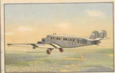
Nr. 19 Junkers G 31b Verkehrsflugzeug auf Landfahrgerüst, Kabine für 18 Fluggäste. 3x550-PS- Siemens-Jupiter-Motoren, luftgekühlt.
