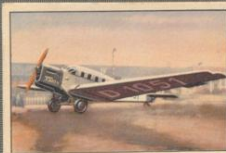
Nr. 18 Junkers G 24 Diesel Verkehrsflugzeug, Kabine für 12 Fluggäste. 720-PS-Jumo 4 Junkers Diesel-Motor, wassergekühlt.
