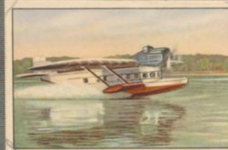
Nr. 22 Dornier „Delphin III“ Kleines Verkehrsflugboot, Kabine für 6 bis 8 Fluggäste. 600-PS-BMW VI Motor, wassergekühlt.
