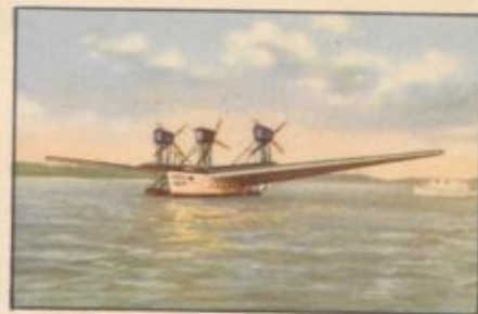
Nr. 2 Rohrbach „Romar“ Verkehrsflugboot, Kabine für 16 Flug- gäste. 3x685-PS-BMW VIIa U Motoren, wassergekühlt.
