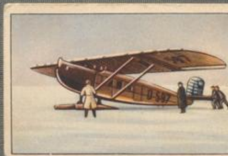
Nr. 23 Dornier „Merkur“ Verkehrsflugzeug auf Schneekufen, Ka- bine für 8 Fluggäste. 600-PS-BMW VI Motor, wassergekühlt.
