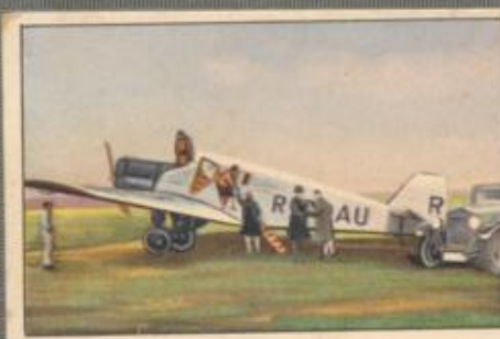
Nr. 16 Junkers F 13 L Verkehrsflugzeug auf Landfahrgestell, Kabine für 4—6 Fluggäste. 265-PS-Junkers L 5 Motor, wassergekühlt.
