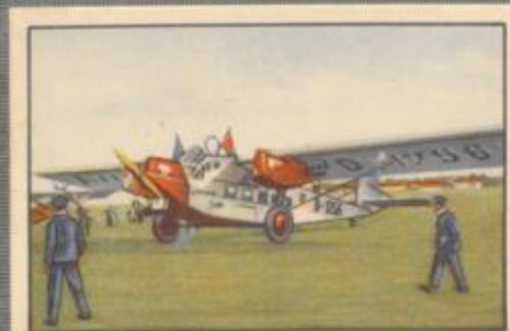
Nr. 1 Rohrbach „Roland“ Verkehrsflugzeug, Kabine für 12 Flug- gäste. 3x350-PS-BMW Va Motoren, wassergekühlt.
