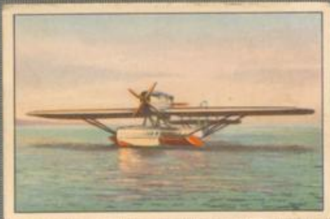
Nr. 25 Dornier „Wal“ Verkehrsflugboot, Kabine für 10–12 Fluggäste. 2x600-PS-BMW VI Motoren, wassergekühlt.
