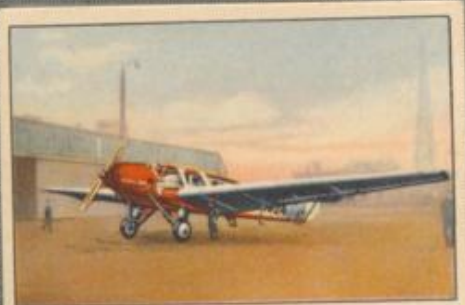
Nr. 9 Albatros L 83 „Adler“ Langstreckenflugzeug für Luftpost und Eildienst. Kabine für Fracht und Passagiere. 280/310-PS-Junkers L 5 Motor, wassergekühlt.
