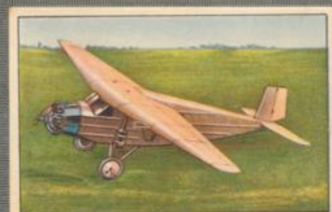
Nr. 10 Messerschmitt B.F.W. M 18d Verkehrsflugzeug, Kabine für 6 Flug- gäste, 200/220-PS-Armstrong-Siddeley- Lynx-Motor, luftgekühlt.
