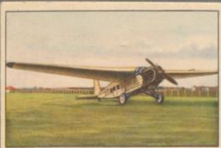
Nr. 13 Messerschmitt B.F.W. M 20 Verkehrsflugzeug, Kabine für 12 Fluggäste. 600-PS-BMW VI Motor, wassergekühlt.
