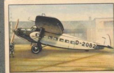
Nr. 12 Focke-Wulf A 38 „Möwe“ Verkehrsflugzeug für Personen- und Frachtbeförderung, Kabine für 10 Flug- gäste, 510-PS-Siemens-Jupiter VI Motor, luftgekühlt.
