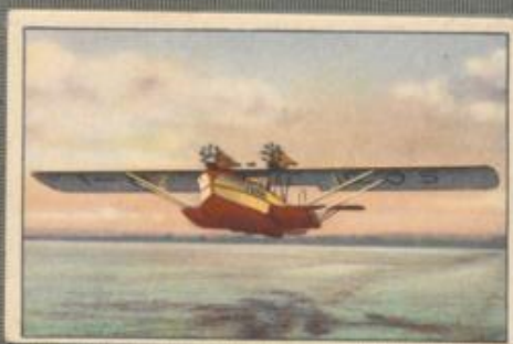
Nr. 26 Dornier „Superwal“ 4 motoriges Verkehrsflugboot, Kabine für 18–20 Fluggäste. 4x450-PS-Siemens- Jupiter VI Motoren, luftgekühlt.
