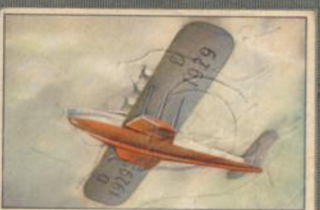
Nr. 30 Dornier „Do X I“ Verkehrsflugschiff, Kabinen für 72 Flug- gäste. 12x600-PS-Curtiss Motoren, wassergekühlt.
