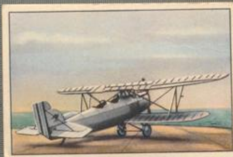
Nr. 3 Heinkel HD 22b 2 sitziges Reiseflugzeug des Luftattachés der Amerikanischen Botschaft Berlin. 310-PS-Junkers L 5 Motor, wassergekühlt.
