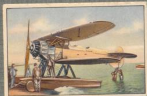
Nr. 3 Focke-Wulf W 4 Freitragender Doppeldecker auf Schwimmern für Post- und Kurierzwecke auf Überseestrecken. 480-PS-Gnôme- Rhône Jupiter Motor, luftgekühlt.
