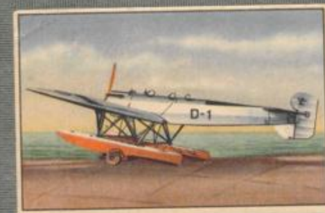
Nr. 5 Heinkel HE 5a 3 sitziges Post- und Kurierflugzeug auf Schwimmern. 600-PS-BMW VI Motor, wassergekühlt.
