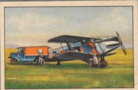
Nr. 10 Albatros L 72c Spezial-Zeitungs-transportflugzeug. 300-PS-BMW IV Motor, wassergekühlt.
