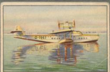
Nr. 28 Dornier „Do S“ Verkehrsflugboot, verbesserter „Super- wal“, Kabine für 20 Fluggäste. 4x465/ 640-PS-Hispano-Suiza-Motoren, wasser- gekühlt.
