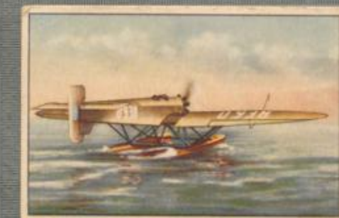
Nr. 6 Heinkel HE 5b Post- und Kurierflugzeug auf Schwimm- ern. 420-PS-Gnôme-Rhône Jupiter Mo- tor, luftgekühlt.
