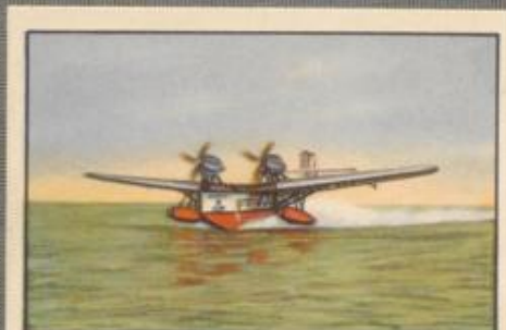
Nr. 3 Rohrbach „Rocco“ Verkehrsflugboot, Kabine für 13 Flug- gäste. 2x650-PS-Rolls Royce Motoren, wassergekühlt.
