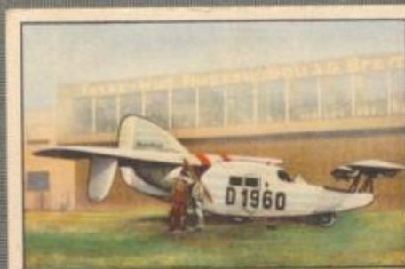
Nr. 9 Focke-Wulf F 19a „Ente“ Verkehrsflugzeug mit vorn liegendem Höhenleitwerk, 2x110-PS-Siemens-Stern- motoren Sh 14, luftgekühlt (links Prof. Focke, rechts Edzard).
