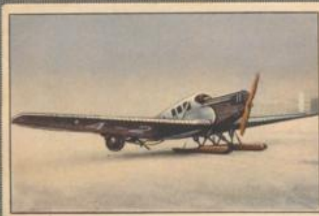
Nr. 15 Junkers F 13 L Verkehrsflugzeug auf Schneekufen, Kabine für 4—6 Fluggäste. 265-PS-Junkers L 5 Motor, wassergekühlt.
