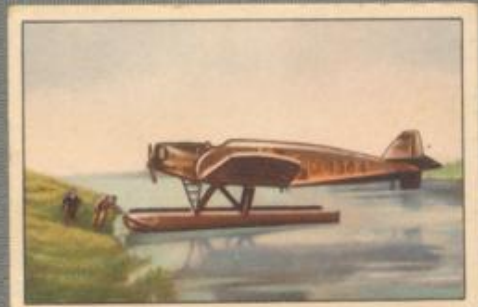
Nr. 2 Junkers W 33 W Frachtflugzeug auf Schwimmern. 310-PS- Junkers L 5 Motor, wassergekühlt.
