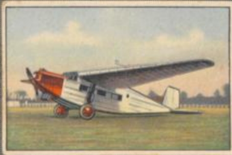
Nr. 14 Messerschmitt B.F.W. M 24 Verkehrsflugzeug, Kabine für 14 Fluggäste. 500-PS-BMW Hornet Motor, luftgekühlt.
