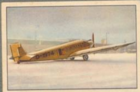
Nr. 1 Junkers Ju 52/1m Großfrachtflugzeug für Langstrecken. Zahlende Last bei 1000 km Flugstrecke: 2150 kg. 685-PS-BMW VIIa U Motor, wassergekühlt.
