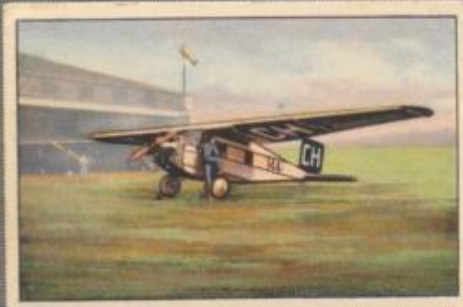
Nr. 5 Messerschmitt B. F. W. M 18 „Photo“ Spezial-Flugzeug für Vermessungsarbeiten, Gipfelhöhe 7000 m. 220-PS-Siddeley-Lynx-Motor, vorverdichtet, luftgekühlt.
