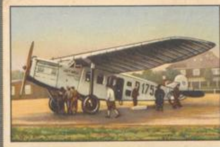
Nr. 8 Focke-Wulf A 29 „Möwe“ Fracht- und Passagierflugzeug, Kabine für 8 Fluggäste, 600-PS-BMW VI Motor, wassergekühlt.
