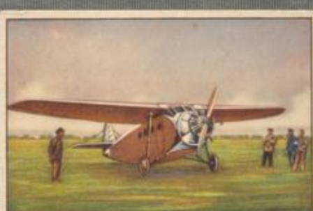
Nr. 4 Focke-Wulf A 33 „Sperber“ Kleinverkehrsflugzeug für Bedarfsluft- verkehr, Kabine für 3 Fluggäste. 145-PS- Walter „Mars“ Motor, luftgekühlt.
