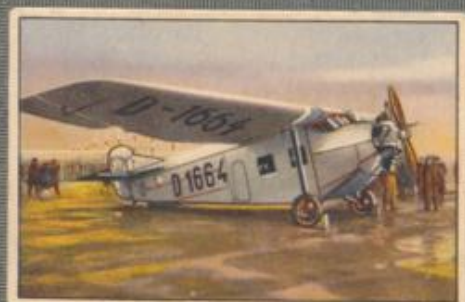
Nr. 5 Focke-Wulf A 28 „Habicht“ trudelsicheres Reise- und Kleinver- kehrsflugzeug. Kabine für 4 Fluggäste. 230/240-PS-Titanmotor, luftgekühlt.
