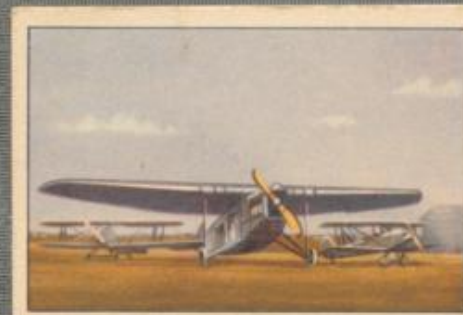
Nr. 6 Focke-Wulf A 21 „Photo Möwe“ Spezial-Konstruktion für Luftbild- und Vermessungszwecke unter Berücksichtigung der Verwendung in großen Höhen. 600-PS-BMW VI Motor, wassergekühlt.
