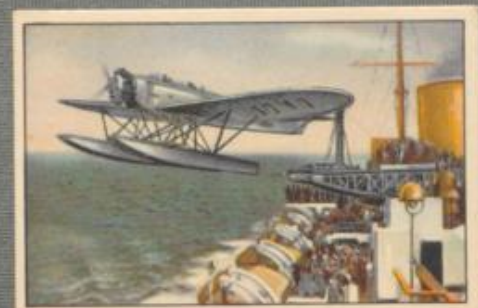
Nr. 4 Heinkel HE 58 Post- und Kurierflugzeug auf Schwimm- ern (Katspult-Flugzeuge der Dampfer „Bremen“ und „Europa“).
