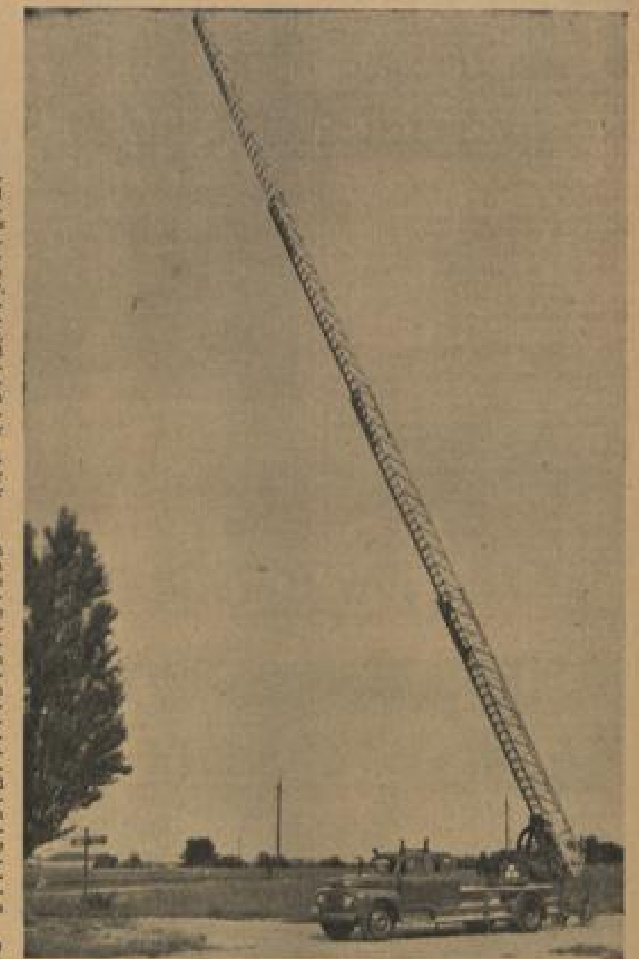
Die Leiter der Firma Metz mit 30 m Steighöhe
