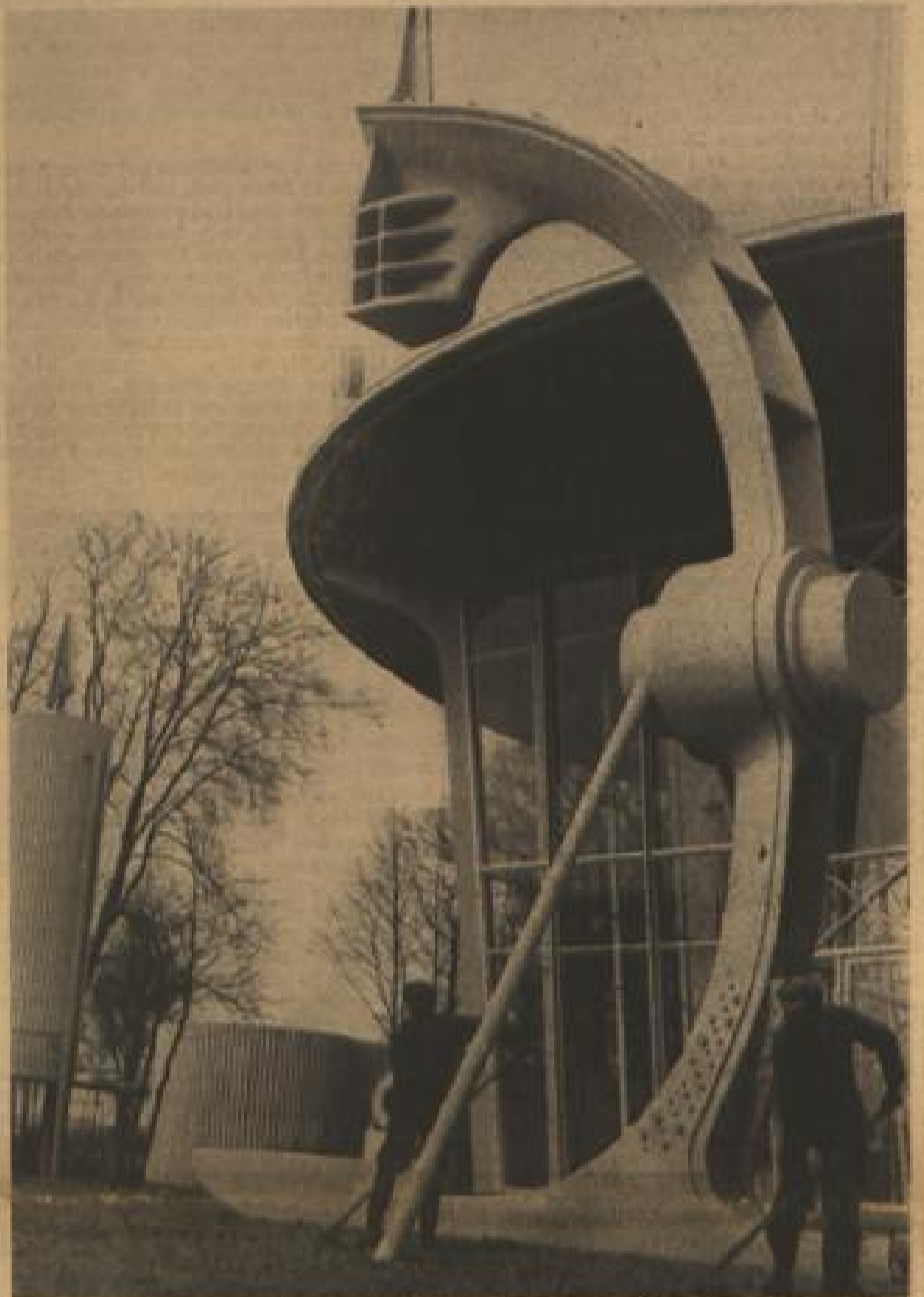
Wie eine moderne Plastik wirkt dieser Achterstern für einen 15.500-Tonnen-Tanker. Der Stahlguß (Gewicht 25.000 kg) hat seinen Platz als Anstellstück auf der Deutschen Industriemesse in Hannover gefunden, die am kommenden Sonntag von Bundeswirtschaftsminister Prof. Ludwig Erhard eröffnet werden wird. An der Eröffnungsfestnahme nehmen ferner Bundesverkehrsminister Dr. Seebahn, Bundespostminister Dr. Balke und das niedersächsische Kabinett teil. Außerdem haben diplomatische und konsularische Vertreter aus 18 Ländern ihr Erscheinen zugesagt.
