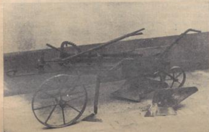
Archiv Wochenblatt (4) Zweischarppflug, bei dem an Stelle des einen Körpers der Untergrundlockerer angebracht ist
