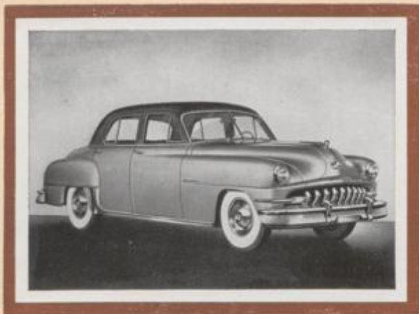
149 DeSoto Custom. Viertürige Limousine. 6-Zylinder-Motor. 4113 ccm. Verdichtung 7:1. 116 PS bei 3600 U/min. Zentrifugal-Wasserkühlung. Fluid Drive, halbautomatisches Getriebe. Höchstgeschwindigkeit 170 km/st. Radstand 2999 mm. Normverbrauch 14 Liter für 100 Kilometer. Baujahr 1951.
