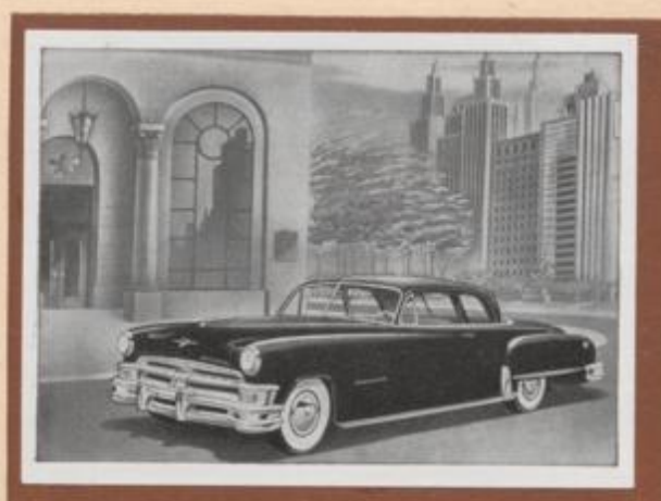
146 Chrysler Imperial, Hochleistungsfahrzeug, Firepower-V-8-Zylinder-Motor, 5424 ccm, Verdichtung 7,5:1, 180 PS bei 4000 U/min, Fluid-Matic-Getriebe, Höchstgeschwindigkeit 180 km/st, Radstand 3340 mm, Normverbrauch 18 Liter für 100 Kilometer, Baujahr 1951.
