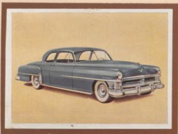
145 Chrysler Typ New Yorker, Hochleistungsfahrzeug, Firepower-V-Achtzylinder-Motor, 5424 ccm, Verdichtung 7,5:1, 180 PS bei 4000 U/min, 120 PS bei 2000 U/min, Fluid-Matic-Getriebe, Höchstgeschwindigkeit 180 km/st, Radstand 3340 mm, Normverbrauch 18 Liter für 100 Kilometer, Baujahr 1951.
