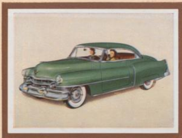
143 Cadillac, General Motors, Stadt-Coupé, 8-Zylinder-V-Motor, 5424 ccm, 160 PS bei 3800 U/min, Höchstgeschwindigkeit 150 km/st, Automatisches Hydra-Matic-Getriebe mit hydraulischer Kupplung, Radstand 3300 mm, Normverbrauch 18 bis 20 Liter für 100 km, Modell 1951.
