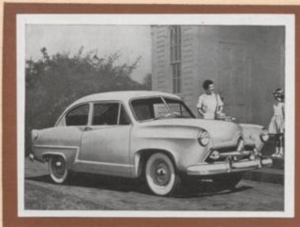
144 Kaiser-Frazer, Modell Henry J, Zweitürige Limousine, 4-Zylinder-Motor, 2200 ccm, 68 PS bei 4000 U/min, Höchstgeschwindigkeit 120 km/st, Radstand 2540 mm, Verdichtung 7:1, Normalverbrauch 10 bis 12 Liter für 100 km, Modell Deluxe: 6-Zylinder-Motor, 2638 ccm, 80 PS bei 3800 U/min, Verdichtung 7:1, Höchstgeschwindigkeit 140 km/st, Baujahr 1951.
