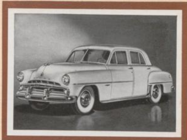
150 Dodge Coronet. Viertürige Limousine der Chrysler Corporation. 6-Zylinder-Motor. 3900 ccm. Verdichtung 7:1. 103 PS bei 3600 U/min. Fluid Drive, halbautomatisches Getriebe. Wahlweise Gyro-Matic-Getriebe. Hydraulische Bremsen. Radstand 3137, bei Achssatz 3491 mm. Höchstgeschwindigkeit 150 km/st. Normverbrauch 16 bis 17 Liter für 100 Kilometer. Baujahr 1951.
