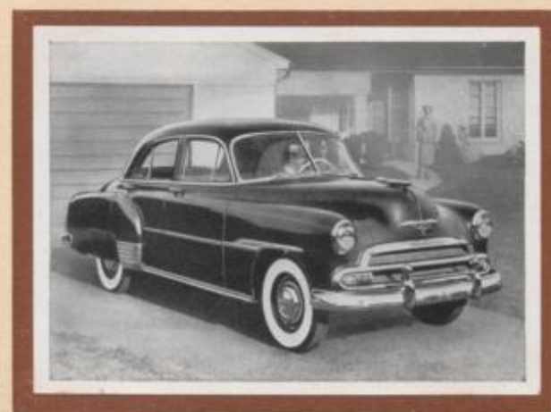
141 Chevrolet Styleline Deluxe 2103. Amerikas meistproduzierter Wagen der General Motors. Viertürige Limousine. 6-Zylinder-Motor, 3549 ccm. Verdichtung 6,7:1. 105 PS. Automatisches Getriebe. Radstand 3505 mm. Höchstgeschwindigkeit 130 km/st. Normverbrauch 14 bis 16 Liter für 100 Kilometer. Modell 1951.
