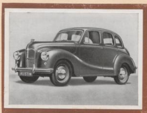
138 Austin A 40. Viertürige Devon-Limousine. Vier-Zylinder-Viertakt-Motor, 1200 ccm. Verdichtung 7,2:1. 46 PS bei 4300 U/min. Höchstgeschwindigkeit 120 km/st. Normverbrauch 8,2 Liter für 100 km. Modell 1951.
