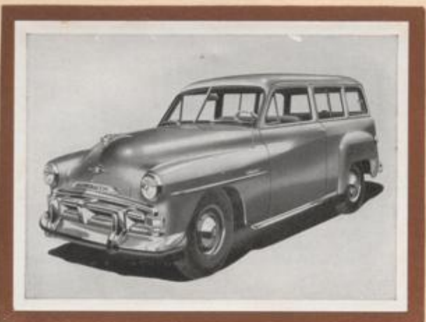
147 Plymouth Utility, Vielseitig verwendbarer Wagen der Chrysler Corporation, 6-Zylinder-Motor, 3569 ccm, Verdichtung 7:1, Wasserkühlung, Ganzstahlkarosserie, 97 PS bei 3600 U/min, Dreiganggetriebe, Höchstgeschwindigkeit 140 km/st, Radstand 2819 mm, Normverbrauch 13 Liter für 100 Kilometer, Modell 1951.
