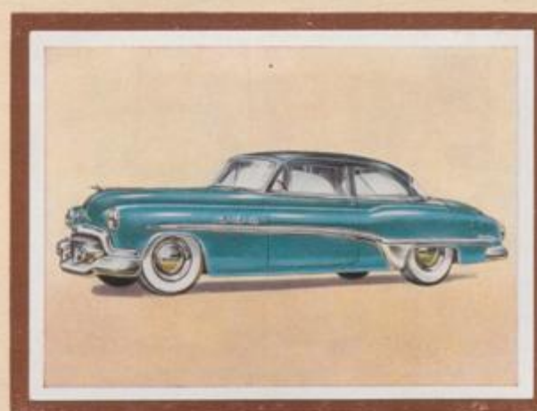
142 Buick Roadmaster Series 70. 8-Zylinder-Motor von 5047 ccm. 152 PS. Dynaflo-Getriebe (hydraulischer Drehmomentwandler). Kein Kupplungsfußhebel. Unabhängige Vorderradaufhängung. Hydraulische Vorderradbremse. Radstand 3308 mm. Wasserkühlung. Baujahr 1951. Höchstgeschwindigkeit 145 km/st.
