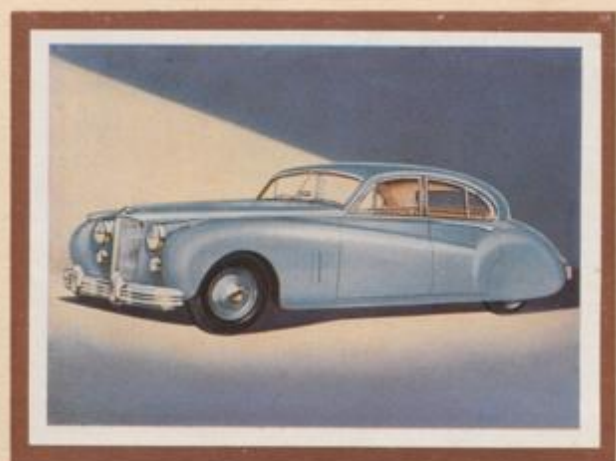
139 Jaguar Mark VII Saloon. Viertürige Limousine. 5 bis 6 Sitze. Ganzstahlaufbau. 6-Zylinder-Motor, 3442 ccm. Verdichtung 7 oder 8:1. 160 PS bei 5000 U/min. Synchronisiertes Viergang-Schneckengetriebe. Höchstgeschwindigkeit 180 km/st. Radstand 3048 mm. Normverbrauch 16 Liter für 100 Kilometer. Baujahr 1951.
