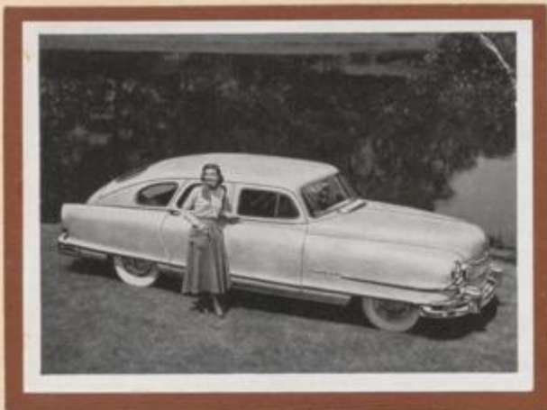
153 Nash Ambassador Custom. Viertürige Limousine mit verlängerter Stromlinien-Heckverkleidung. 6-Zylinder-Motor. 3847 ccm. Verdichtung 7,3:1. 115 PS bei 3400 U/min. Warner-Dreiganggetriebe, wahlweise Hydra-Matic-Getriebe. Höchstgeschwindigkeit 145 km/st. Radstand 3073 mm. Normverbrauch 13 Liter für 100 Kilometer. Modell 1951.
