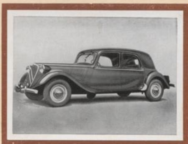
140 Citroën «15». Ganzstahlkarosserie. 6-Zylinder-Motor. Kopfge-steuert, 2867 ccm. 78 PS bei 3700 U/min. Frontantrieb. Höchstgeschwindigkeit 130 km/st. Dreiganggetriebe, zwei Gänge synchronisiert. Zahnstangenlenkung mit automatischer Einstellung. Torsionsstabfederung und Teleskop-Stoßdämpfer. Länge über alles 4750 mm. Normverbrauch 13 bis 15 Liter für 100 Kilometer. Modell 1951.
