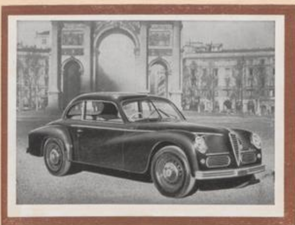
137 Alfa Romeo Supersport 2500 Gran Turismo. 6-Zylinder-Motor, 2443 ccm. Drei Vergaser, Verdichtung 7,5:1. Schräg hängende Ventile, 105 PS, bei 4800 U/min. Höchstgeschwindigkeit 160 km/st. Lenkradschaltung. Vier synchronisierte Gänge. Vollschiebende Hinterachse. Radstand 3000 mm. Normverbrauch 14,5 bis 15 Liter für 100 km. Baujahr 1951.
