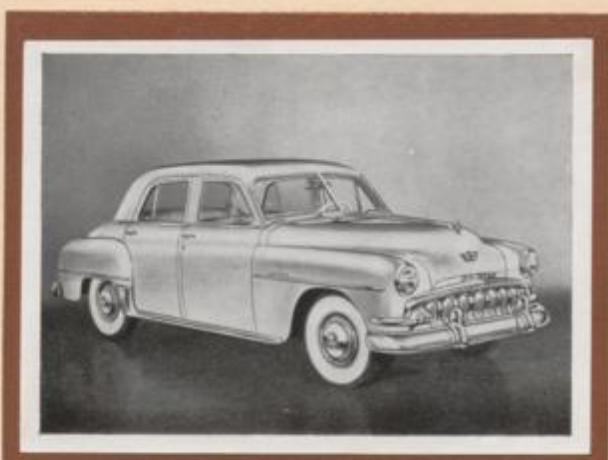
148 De Soto Diplomat, Viertürige Limousine der Chrysler Corporation, 6-Zylinder-Motor, 3569 ccm, Verdichtung 7:1, 97 PS bei 3600 U/min, Dreiganggetriebe, Höchstgeschwindigkeit 155 km/st, Radstand 2819 mm und 2999 mm, Hydraulische Vierradbremse, Normverbrauch 13 Liter für 100 Kilometer, Modell 1951.
